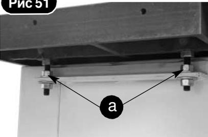
Гайки регулирования высоты стола станка (a)
