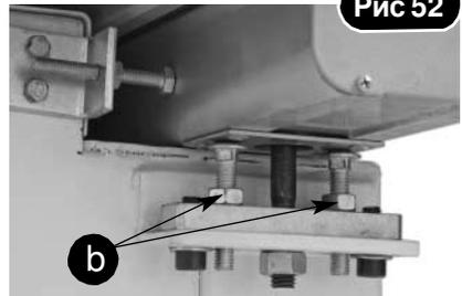
Гайки регулирования высоты подвижного стола (b)
