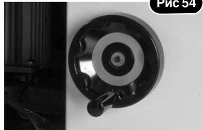
Маховик установки угла наклона шпинделя,
