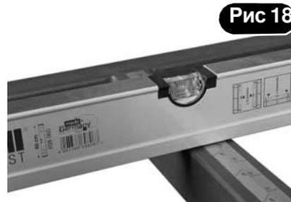
Положите строительный уровень на удлинение стола (**B1**) и выровняйте его, вращая четыре гайки на опорном стержне (**B7**) с помощью двух гаечных ключей (см. рис 17 и 18).
