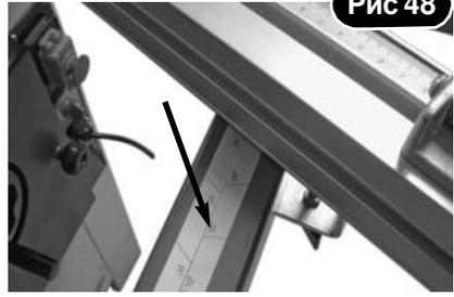
Шкала угла поворота упора рамы удлинения
